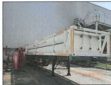
รูปที่ 3-46 การเก็บก๊าซไฮโดรเจนที่มีอากาศถ่ายเท
